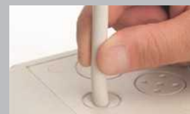
Membrana bimaterial dispuesta para instalar cable directamente garantizando un grado de protecció IP65 Bi-injection membrane for a direct cable entry without the need to cut or drilled it guaranteing an IP65 protection degree
