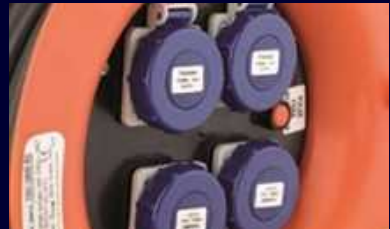
Tomas industriales IP67 que garantiza la máxima seguridad en ambientes con mucho polvo y humedad.
